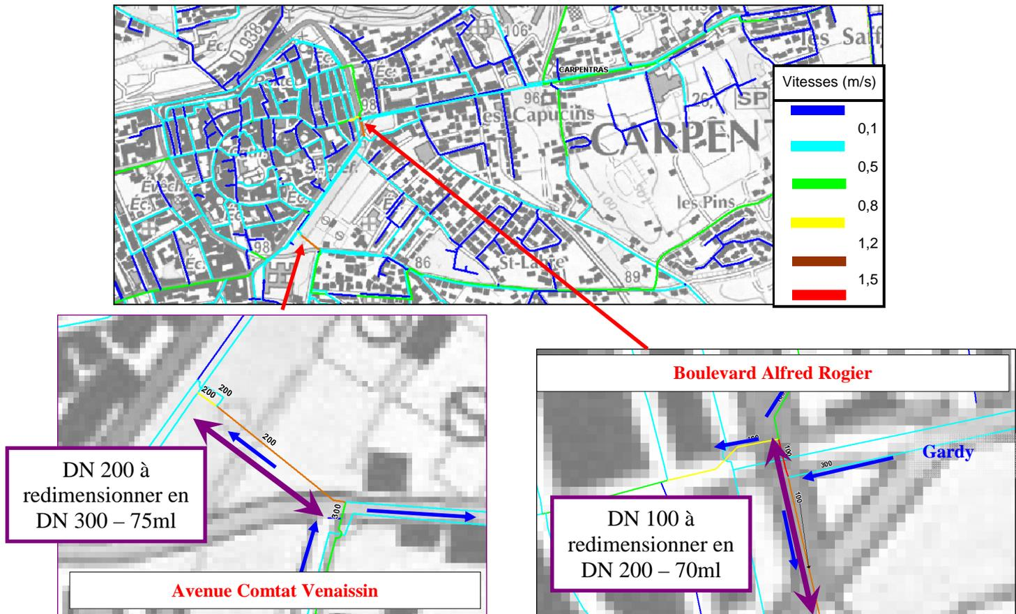
Figure 3-8 : Préconisation - Sous-dimensionnement réseau distribution Carpentras
