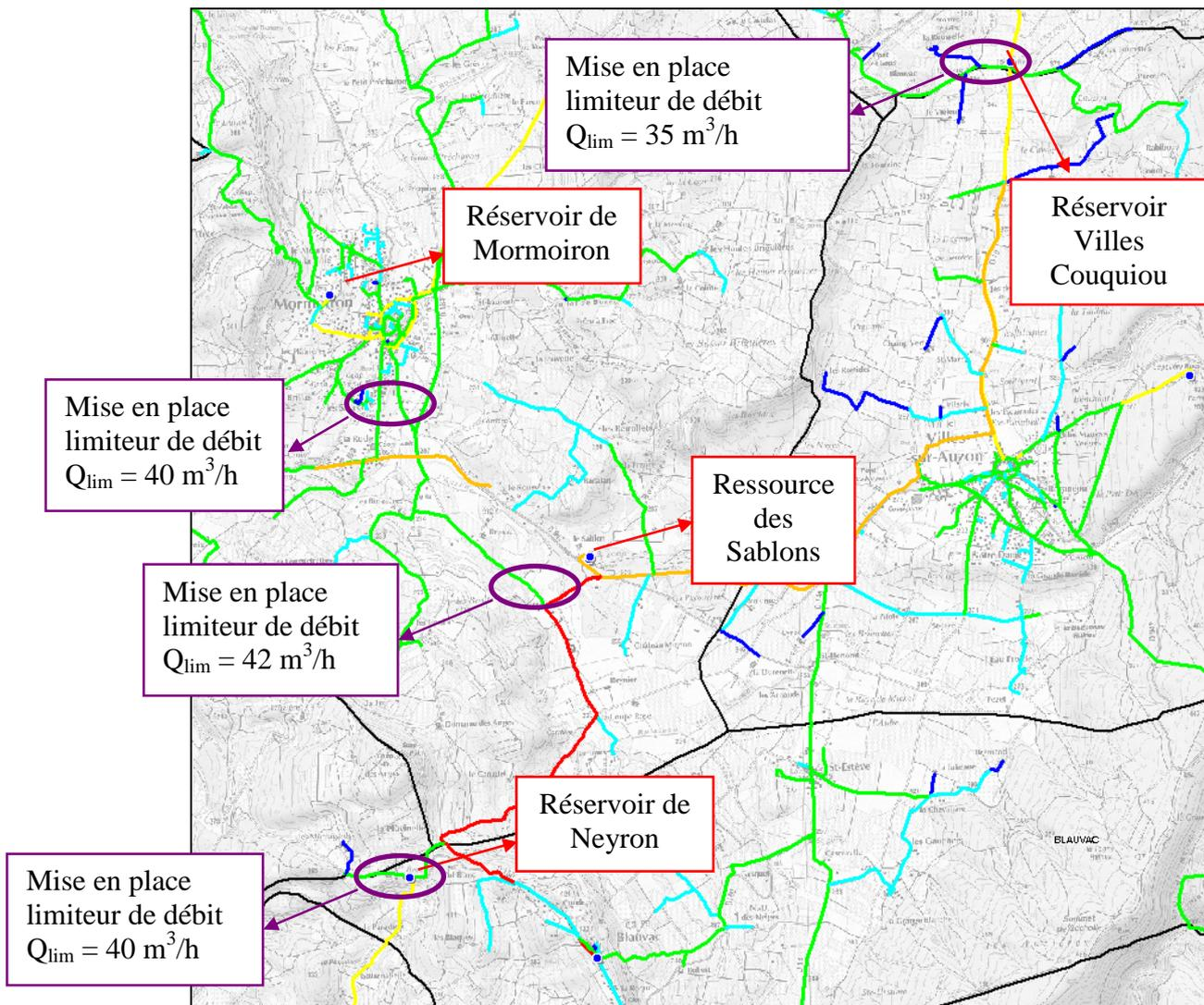
Figure 3-25 : Préconisation – structure alimentation service Sablons
