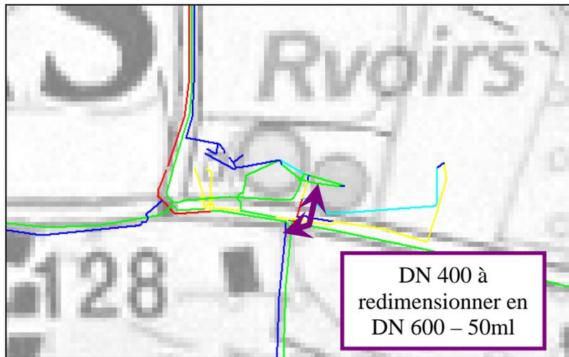
Figure 3-11 : Préconisation de travaux – conduite adduction La Gardy
