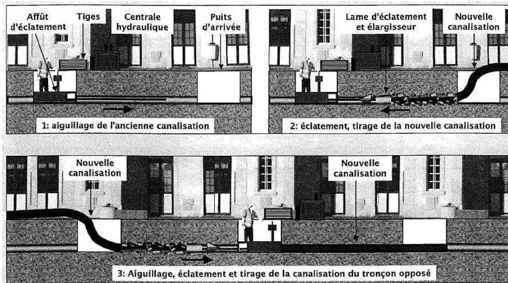
Figure 4-18 : Schéma de principe de l'éclatement statique (source : RESEAUXRST, 2008)
