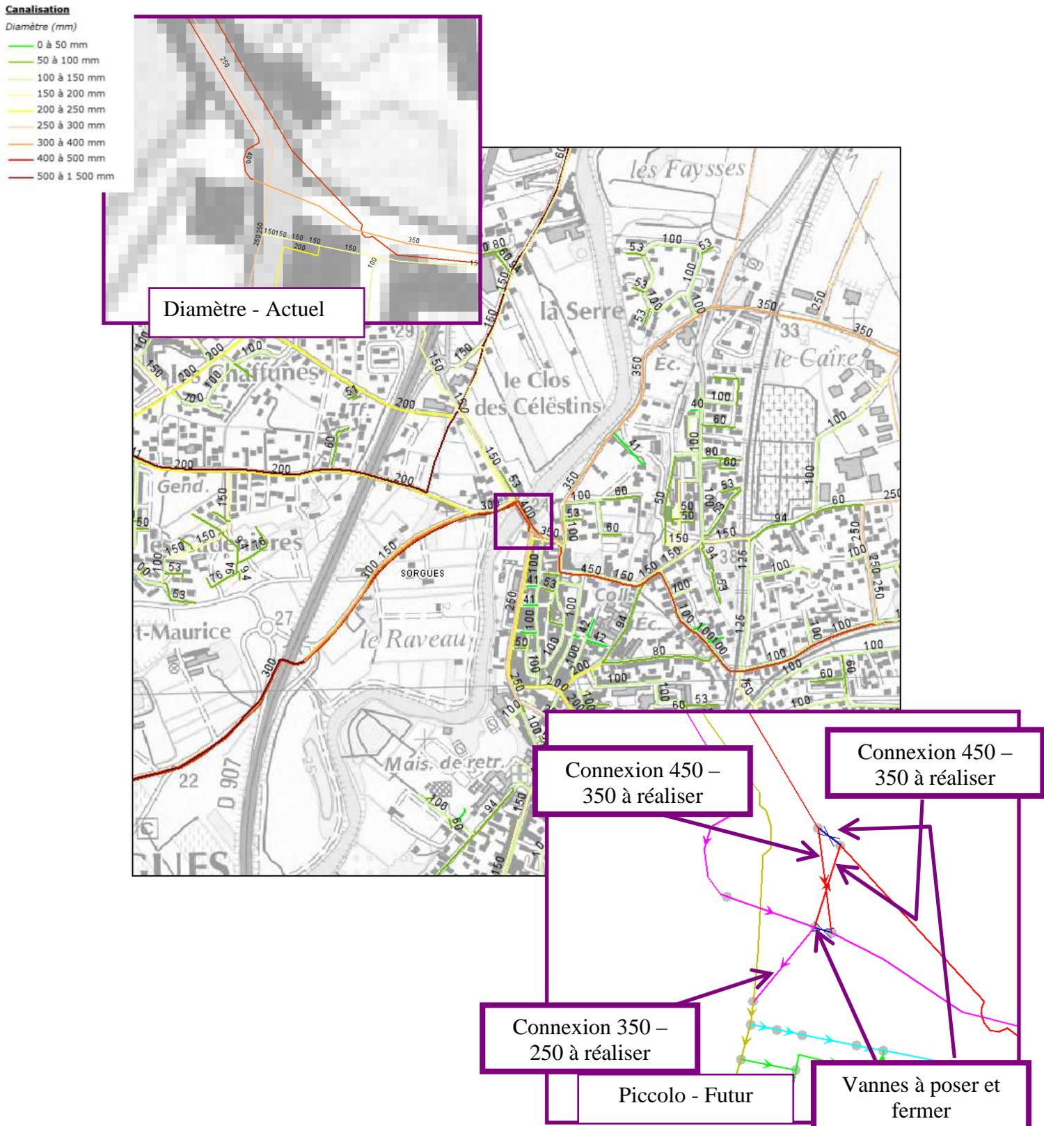
Figure 4-4 : Connexion – Déconnexion B : Aval pont de l'Ouvèze
