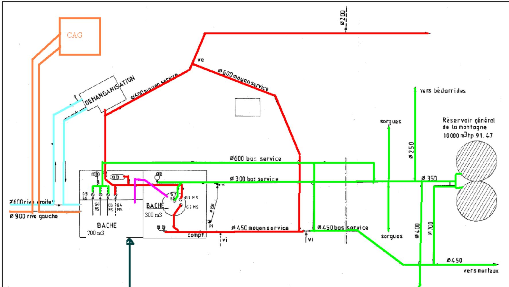
Figure 4-24 : Fonctionnement détaillé de la station de pompage de la Jouve
