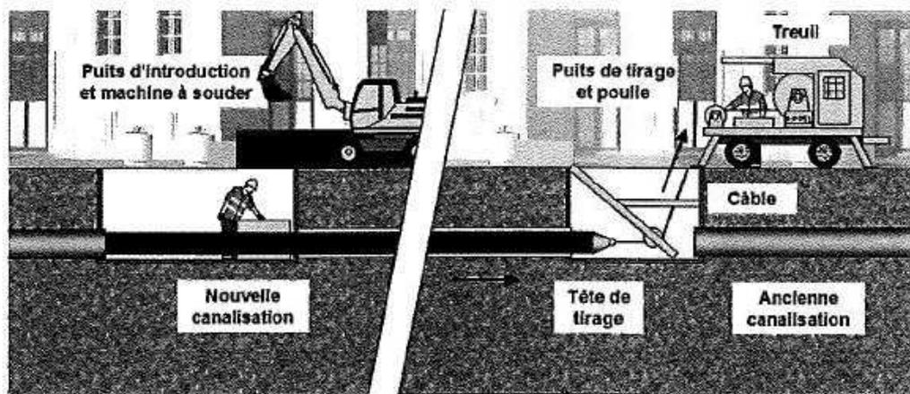
Figure 4-17 : Tubage avec espace annulaire (source : RESEAUXRST N°59)
