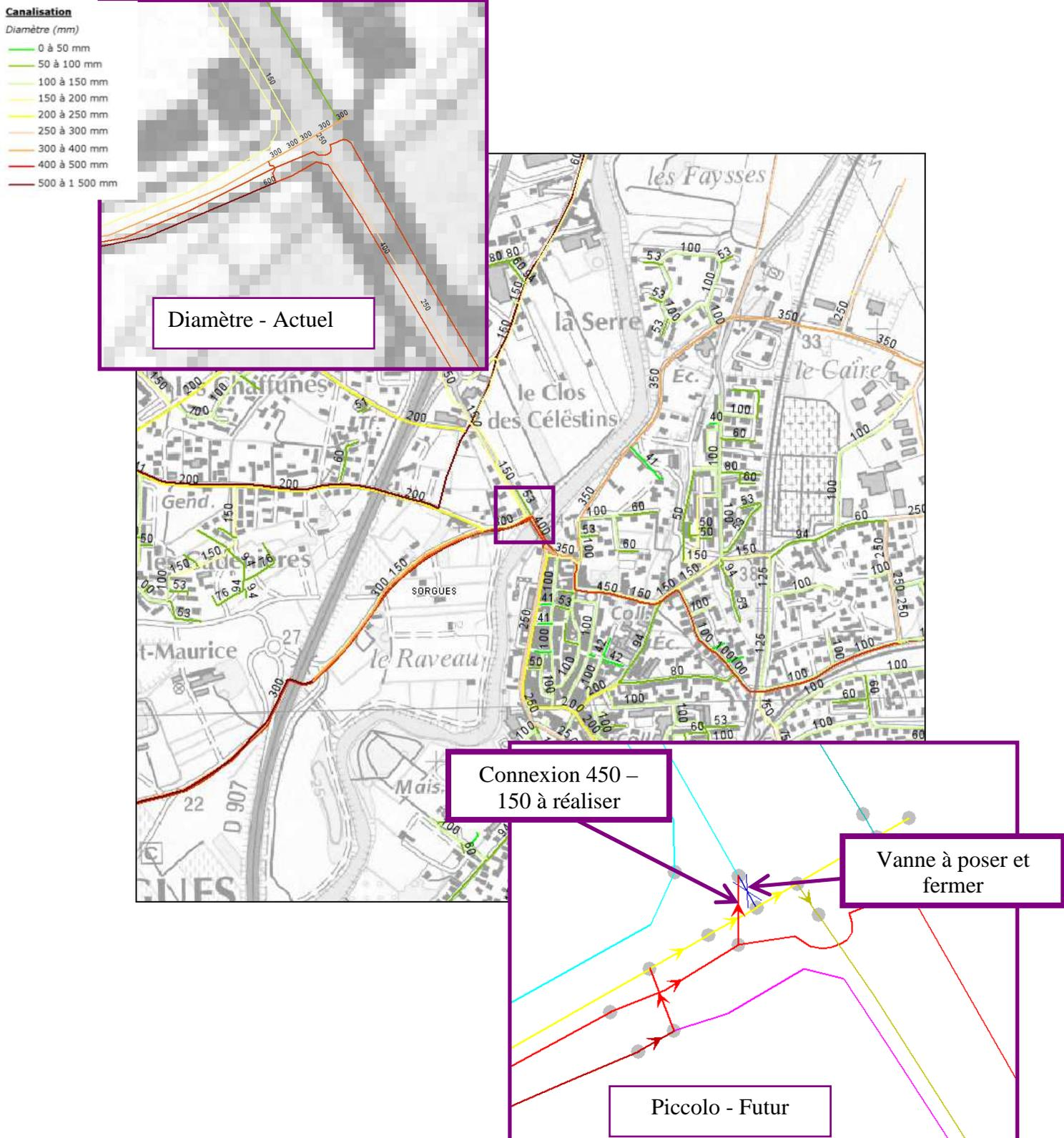
Figure 4-3 : Connexion – Déconnexion A : Amont pont de l'Ouvèze
