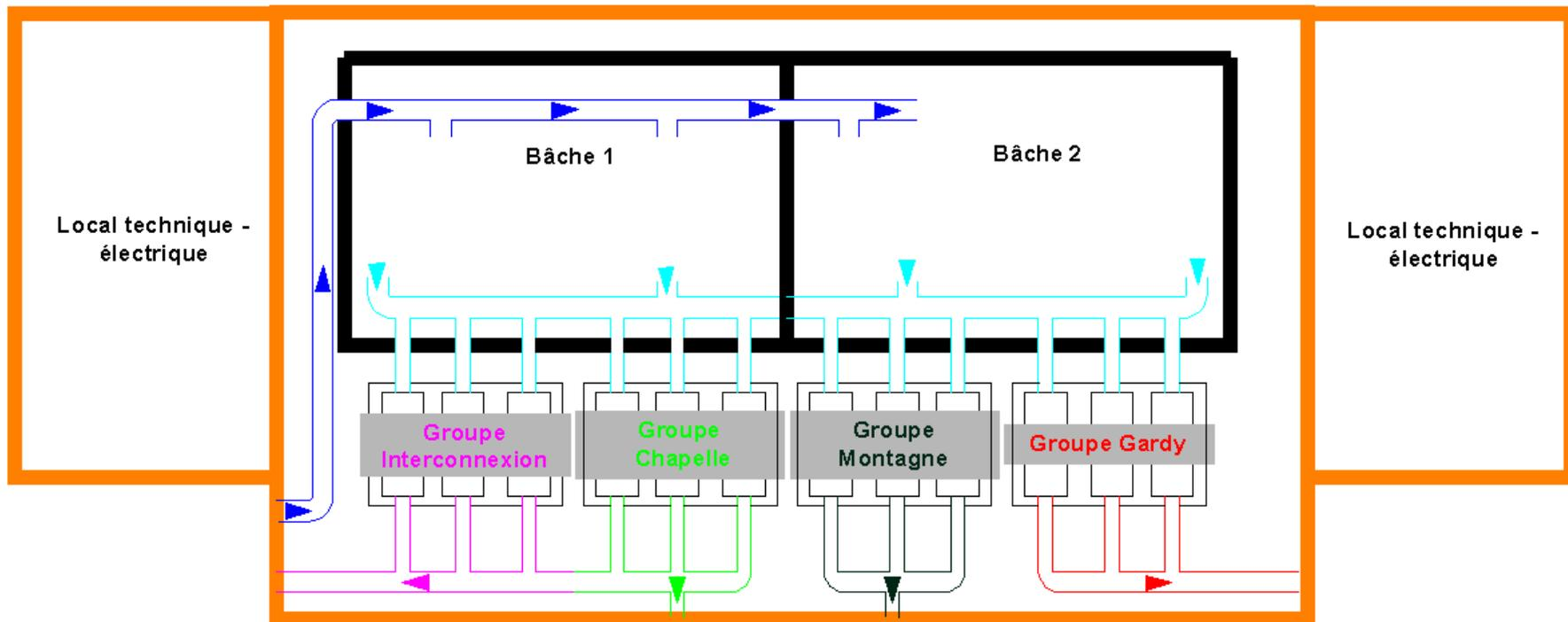
Figure 4-32 : APS n°4 – Station La Jouve – Principe hydraulique futur
